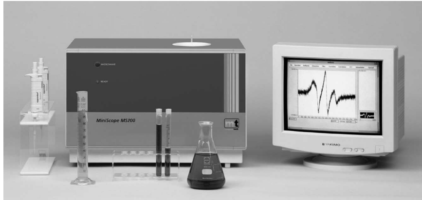
Abb. 4.3-1 Tisch-ESR-Spektrometer MiniScope MS200 (Magnettech GmbH, Berlin)
