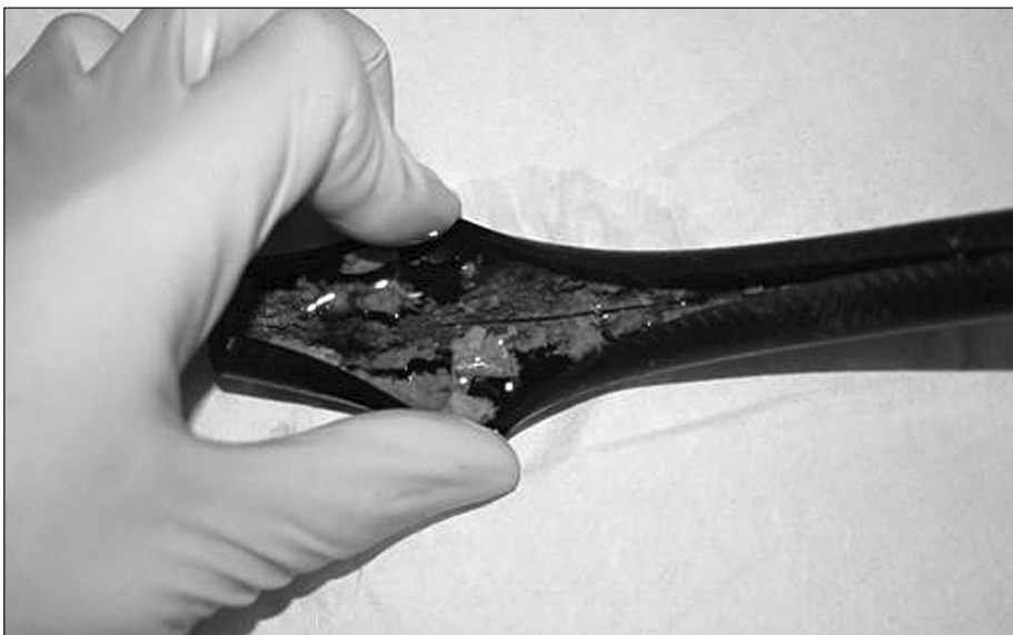
Abb. 4.2-1: Sichtbarer Biofilm in einem aufgeschnittenen Duschschauch. Photo von Prof. Szewzyk (TU Berlin).
